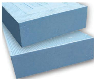
Pannello isolante per zoccolature in polistirene espanso sinterizzato azzurro classe 150 stampato, ad assorbimento d'acqua ridotto, per sistemi di isolamento termico secondo EN 13163, marcato CE tipo ETICS. Grazie alla zigrinatura su una faccia e al disegno a scacchi sull'altra, offre una grande adesione ai collanti.
